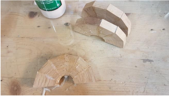
Figuur 6: lijmen in helften van de ring
